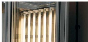
FYT D – zářivky ve dveřích komory
