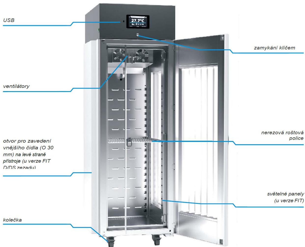
Klimatická komora KK 500 P Smart PRO FIT DS
